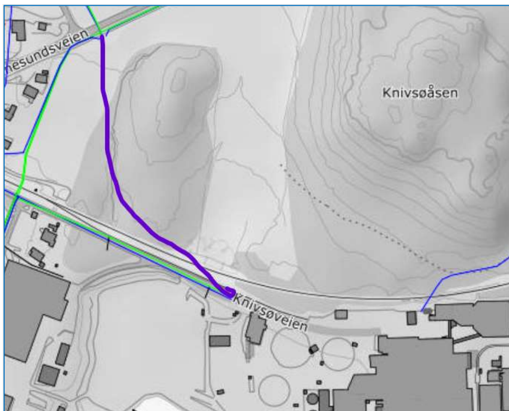
Figur 4 Kartutsnitt viser også planlagt ny 355mm PE fra kommunens ringledning (ref. Gemini VA HK)
