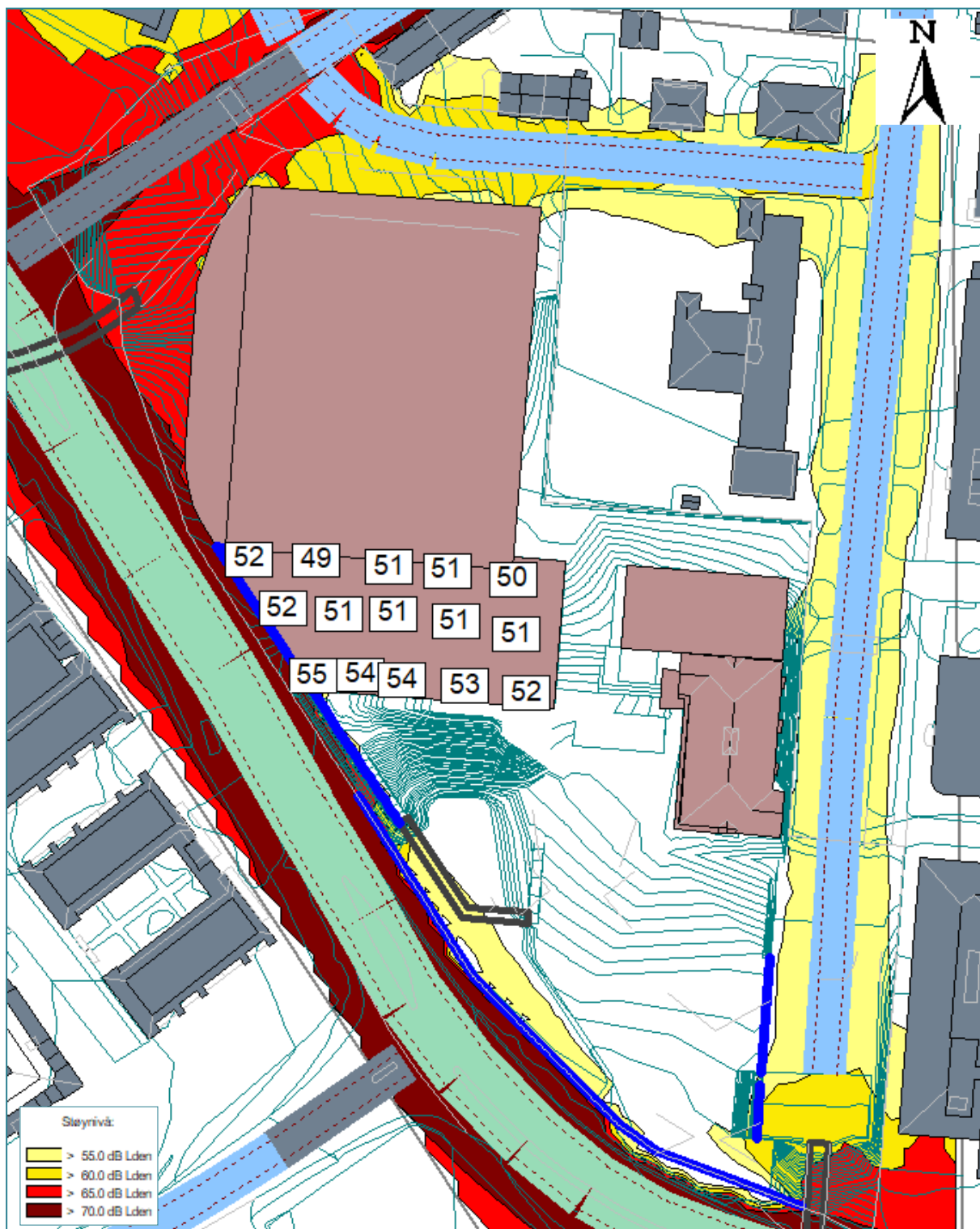
Figur 4-5: Støysituasjonen beregnet 1,5 meter over terreng med skjermer på høyde 2,75 meter og 2,5 meter.
