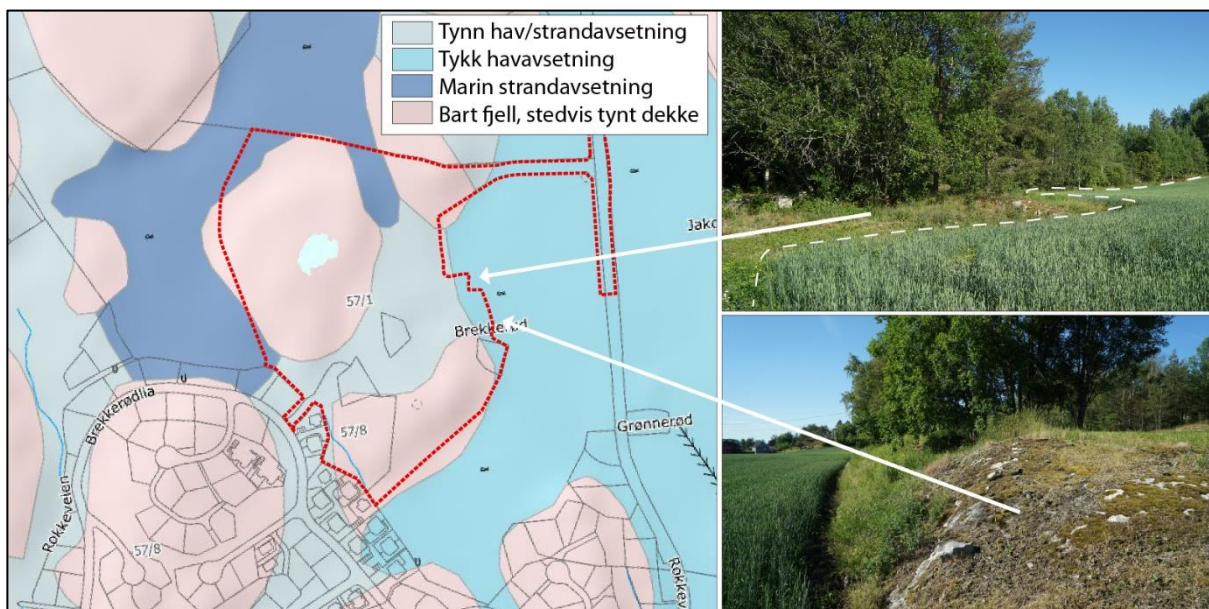
Figur 4. Utsnitt av løsmassekart for området (NGU), med plangrensen markert med rødt. Fotografiene er tatt i kanten av jordet, og viser fast fjell der kartet markerer tykk havavsetning.
