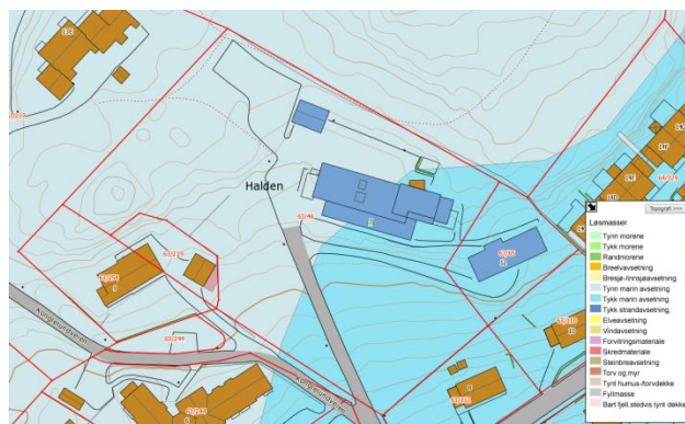
Figur 5 Oversikt over løsmassene på Konglelundområdet [6].
