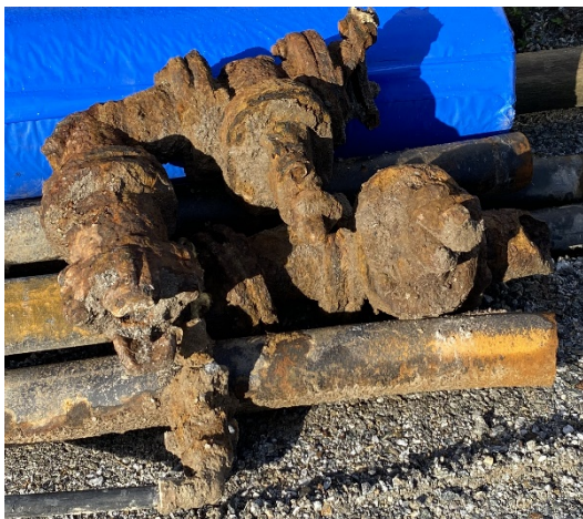
Gammel ventil som er byttet ut i forbindelse med saneringsplan i Hovedplan 2021-2024
