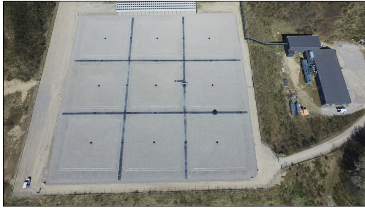
Figur 13 Viser hvordan det flytende lokket synes ovenfra. Fra presentasjon til Aalborg CSP, Jonas Sørensen, Webinar "Fjernvarme i Halden, 2. samling", 2023.
