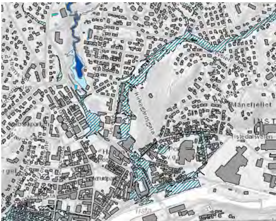
Figur 7 Utsnitt fra Schultzebekken sør. Flere områder der bekken går i rør er markert som lavpunkt, hvor det kan samles vann dersom ledningsnettet ikke klarer å ta unna vannmengdene.
