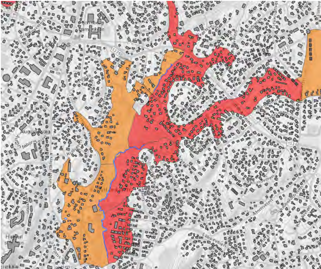
Figur 13 Konsekvenskart for kvikkleireskred. Her utsnitt fra Schultzebekken sør. Rødt er høy konsekvens, oransje middels.
