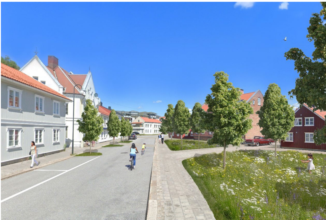
FIG. 37 FORSLAG TIL PRINSIPPLØSNING – SMALERE GATE, SEKUNDÆRSYKKELVEI I BLANDET TRAFIKK OG GRØNNE AREALER
