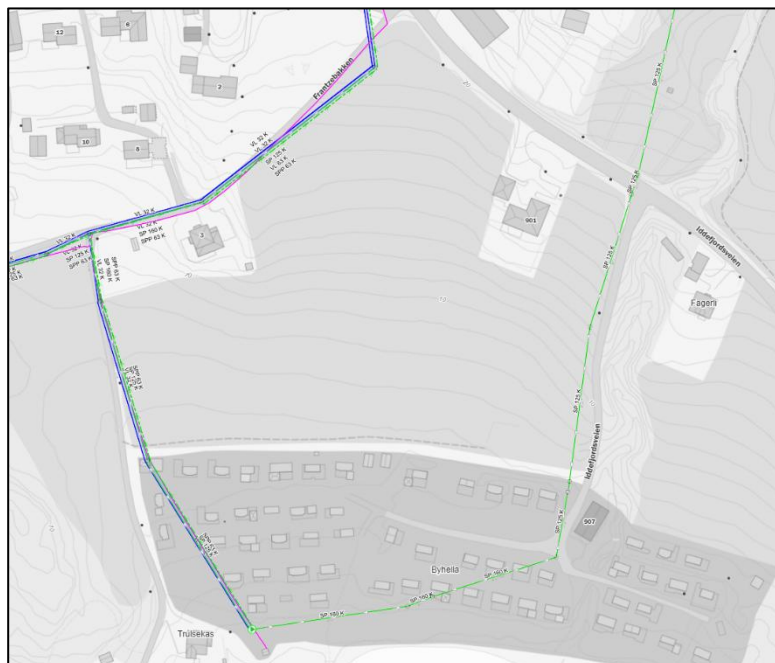
Figur 7. Kartutsnittet viser framføring av kommunale vann-, og avløpsledninger i området. Servicehuset, som tidligere fikk vann fra egen brønn, er tilknyttet anlegget med privat stikkledning.
