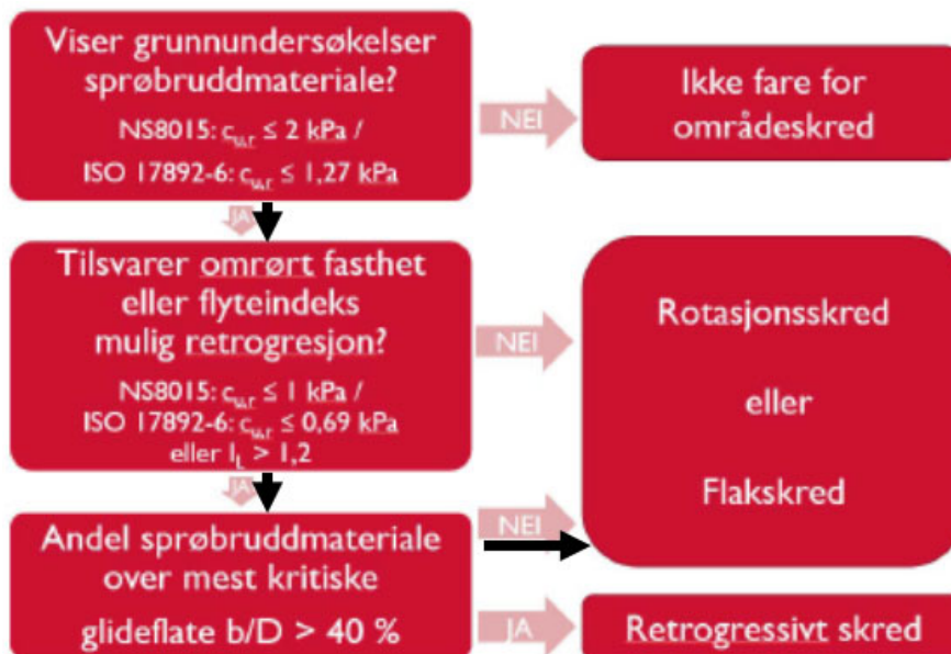
Figur 4-6: Flytskjema for vurdering av aktuell skredmekanisme, ref. [4].
