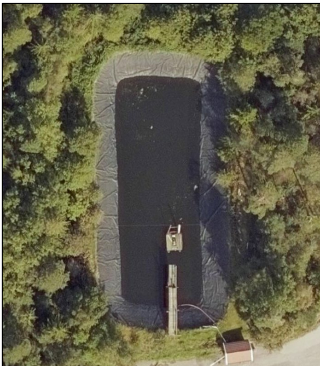
Figur 16: Flybilde av dagens vannbasseng (vannbehandlingsdam) som viser nedtappet situasjon. Dammen er kledd med sveiset duk og er tett.
