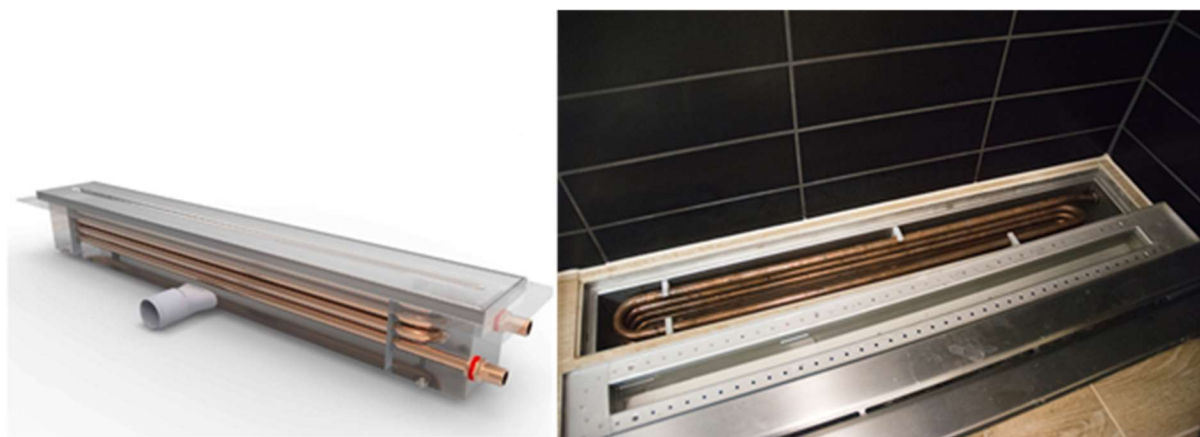
Figur 2.4 - Eksempel på indirekte gråvannsgjenvinner i form av en «avløpskassett» for dusjvannsløp. Kaldtvann sirkulerer i kobberrør som vist i figurene, og varmes opp av gråvann som renner gjennom kassetten (produkt illustrert: HXDrain).
